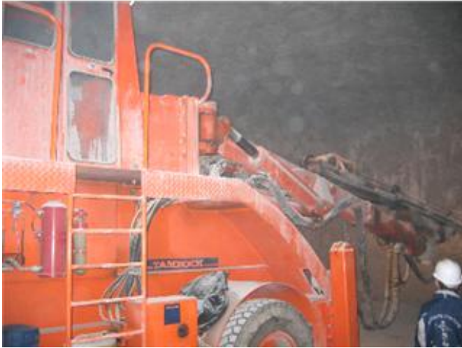
La foreuse creuse un trou où l'on met les explosifs
