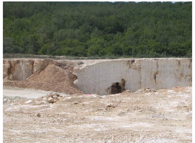
La paroi dynamitée : trace des forages
