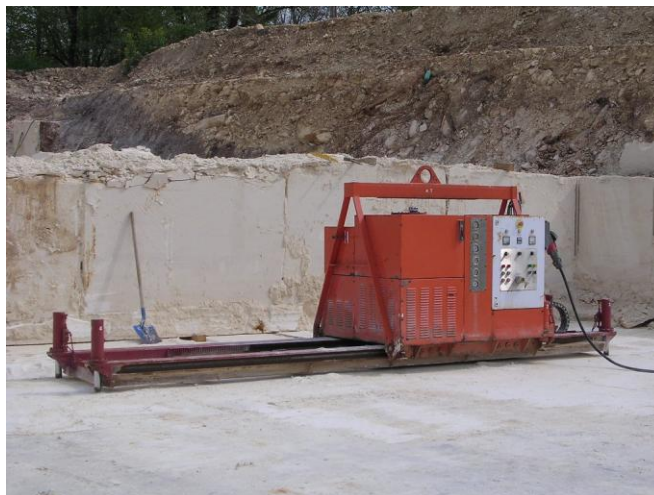
Machine à découper les blocs
