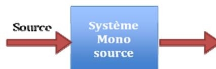
Un **système mono source à production combinée** est une application particulière : il véhicule ou produit des flux de charge multiple (chaleur et électricité par exemple) à partir d'une seule source d'énergie :
