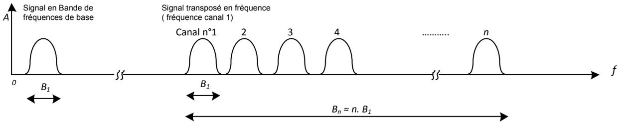
Exemple typique : multiplexage fréquentiel en télévision
