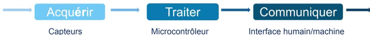
**Les capteurs** servent à **acquérir des informations sur l'environnement de l'objet technique**. Les capteurs **transforment une grandeur physique** (température, présence, etc.) **en un signal électrique**. Ce signal est ensuite transmis au microcontrôleur pour traitement.
