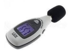
Un sonomètre est un instrument destiné à mesurer le niveau de pression acoustique, une grandeur physique liée au volume sonore.
