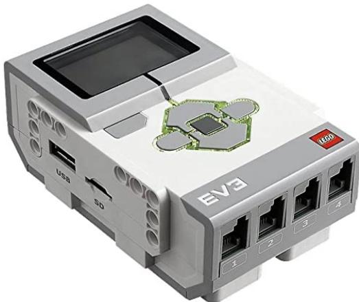
*La brique EV3 est le centre de commande et d'alimentation électrique du robot.*
