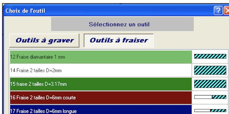
Quand les perçages sont d'un diamètre supérieur à celui de la fraise installée sur la broche, il est préférable de les réaliser en contournage avec la fraise. Ceci permet d'éviter un changement d'outil fastidieux.
