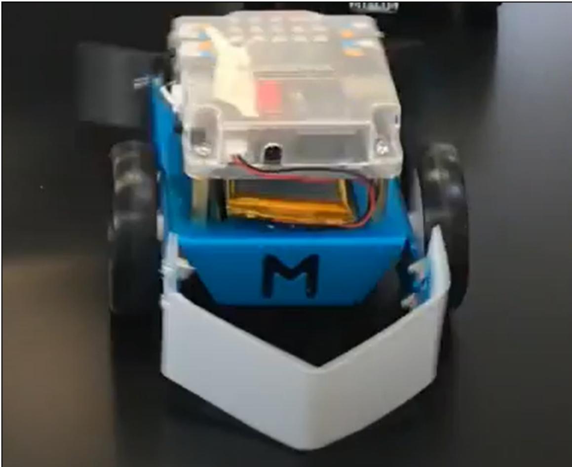
Robot Sumo : Pare choc découpé et thermoplié
