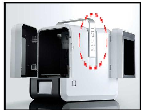
Pour une impression à partir d'ABS dans une imprimante 3D UP Mini 2, il sera nécessaire de **fermer les aérations supérieures** en abaissant la poignée de transport pour bloquer les courants d'air ainsi que les deux portes.
