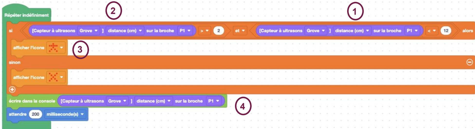
1- **Comparer** si la variable contenant la distance mesurée par le télémètre ultrason est inférieure à un **seuil limite (ici 12 cm)**.
