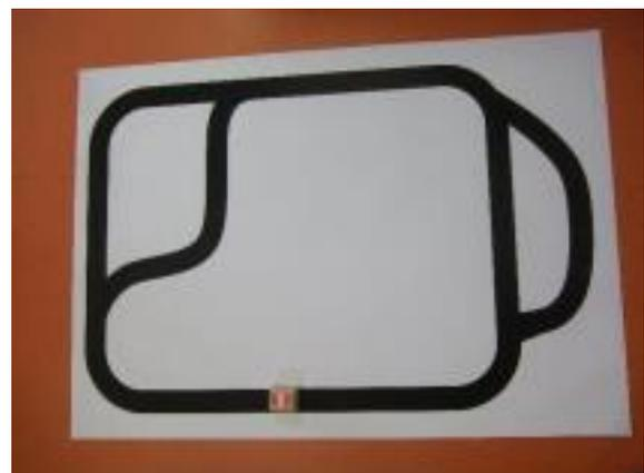
Niveau 3 : Le robot suit seul le circuit. Si un obstacle est placé sur une ligne droite, il contourne l'obstacle et poursuit le circuit. (15 points)
