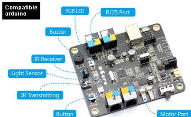
La platine dispose d'une prise USB afin que vous puissiez la programmer via l'environnement de l'arduino. Elle dispose également:
