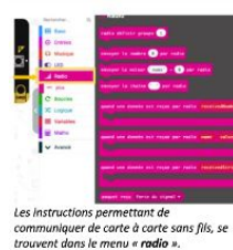
Choisir un groupe (de communication) commun aux deux cartes qui veulent communiquer. (ce groupe peut s'apparenter à un canal de communication, permettant de ne pas mélanger les signaux envoyés).
