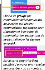
La variable « receivedNumber » contiendra la valeur Numérique envoyée par radio (Quand B a été pressé). Il suffit de la faire glisser dans l'instruction « afficher ». La variable « receivedString » contiendra le texte envoyé.
