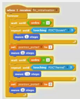
la modélisation d'un portail automatisé pour simuler le fonctionnement à l'aide du logiciel scratch
