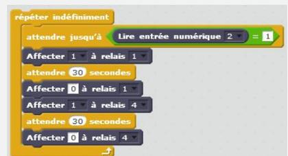
Des **outils** et des **langages de description** permettent de **décrire le fonctionnement** et le **comportement** d'un objet technique. Pour décrire son **fonctionnement d'un objet**, on recherche ses **fonctions** que l'on repère dans des **blocs fonctionnels**. Pour décrire le **comportement** d'un objet, on détermine comment il **agit** avec son **environnement**.
