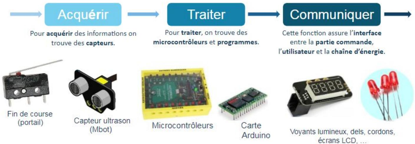
La **chaîne d'information** est la partie du système technique qui **capte des informations** issues de l'**utilisateur** ou de l'environnement extérieur, et qui la **traite** avant de **communiquer** avec la **chaîne d'énergie**.
