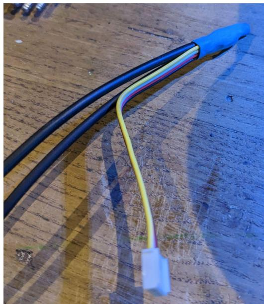
*Isoler avec de la gaine isolante.*
