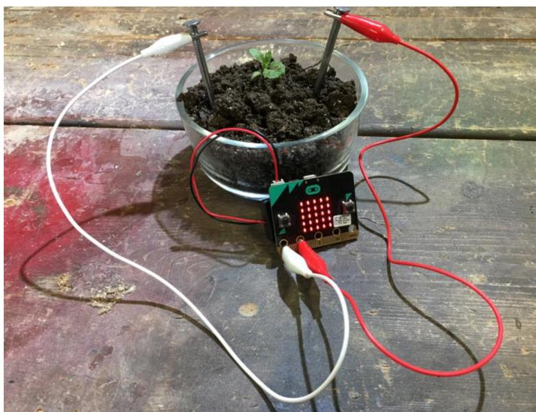
Le détecteur d'humidité peut être construit avec des clous et des cordons de test.
