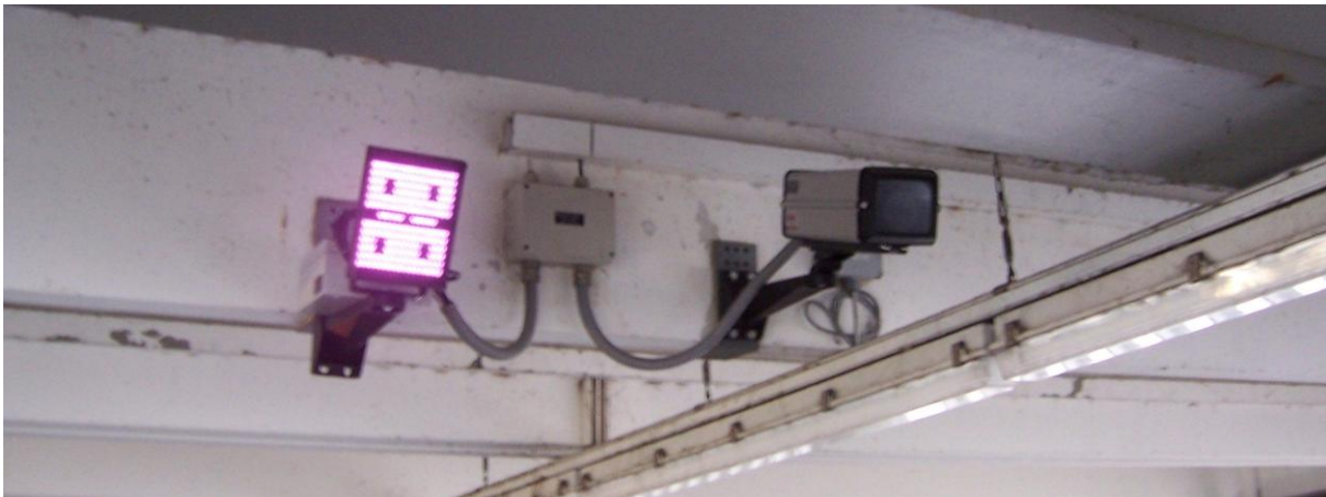
Système de surveillance utilisé en Suisse et en Allemagne. Il comprend un système de reconnaissance faciale, de reconnaissance de véhicule (marque, modèle, couleur) et un lecteur de plaque d’immatriculation.
