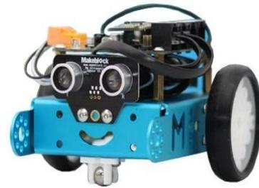
Le robot **mBot** interagit avec son environnement en fonction du programme qu'on lui implante. Pour cela, il est capable de collecter des informations grâce **à ses capteurs** et de réaliser des actions grâce **à ses actionneurs**.
