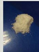
J'en conclus que: quand l'eau commence à chauffer, de petites bulles apparaissent, l'eau boue. L'eau s'évapore, le volume diminue. Quand toute l'eau est évaporée, il ne reste plus que le sel au fond du bêcher.
