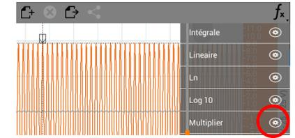
Paramétrez la fenêtre de façon à multiplier l'intensité et la tension, puis appuyez sur OK.
