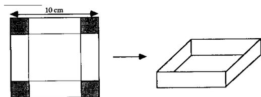
On dispose d'une plaque de carton carrée de 10 cm de côté. Dans chaque coin de la plaque, on découpe un carré comme indiqué sur le dessin. On obtient alors le patron d'une boîte parallélépipédique, sans couvercle.
