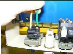
Connecter un tuyau « vert » Ø4, sur la sortie du bouton poussoir
