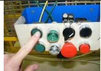
Procéder à l'essai ; en appuyant sur le bouton poussoir, le voyant pneumatique « s'allume »
